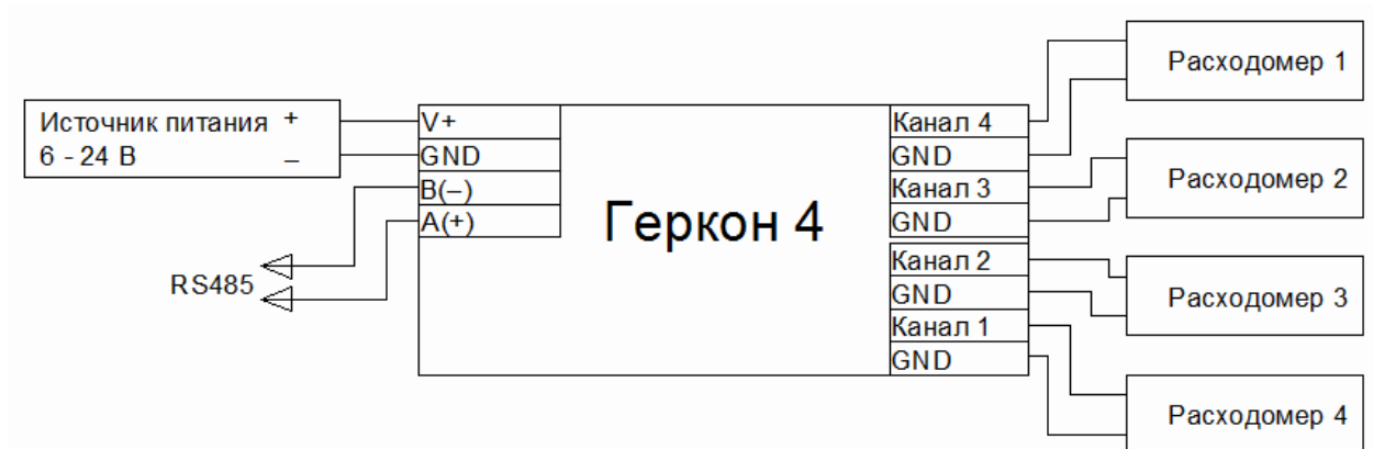
Рисунок 2 Схема подключения счетчика импульсов Геркон 4
